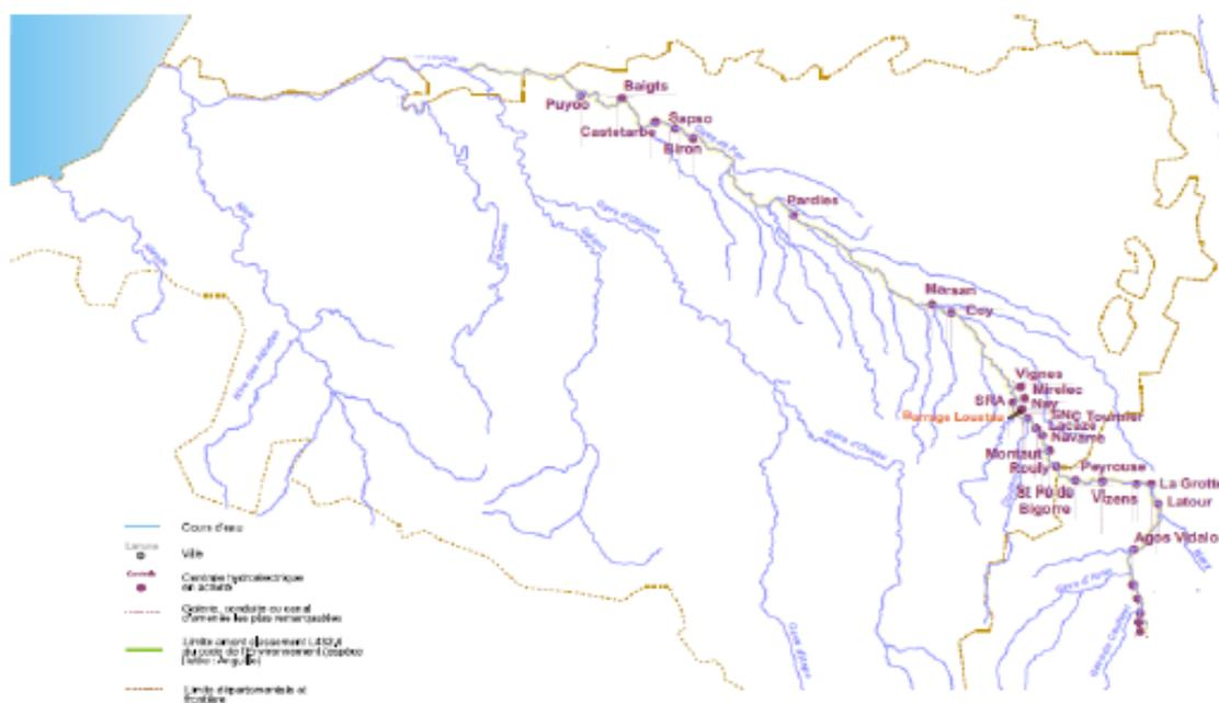
Le Gave de Pau avec 36 850 kW installé à l'aval d'Argelès fin 2009 est la rivière la plus équipée. La majorité de la production est réalisés par des usines (environ 189) à des producteurs indépendants. Les dérivations pour alimenter certaines de ces centrales concernent 16 km du cours d'eau.
